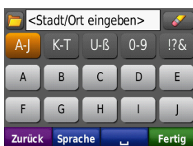
Extra große Tasten zur Bedienung mit Handschuhen
